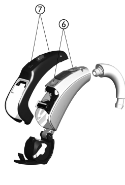
Figure 3: a) Boîtier Spice+ H2O b) Vue éclatée du boîtier Spice+ H2O
